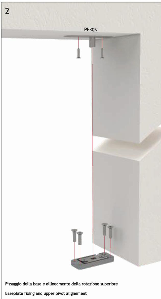
Fissaggio della base e allineamento della rotazione superiore
